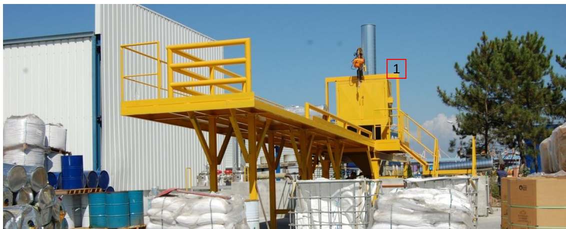
Figura 14 – Novo fundidor de colofónia
